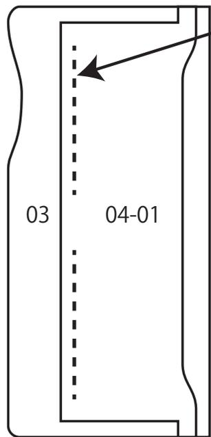
03 と 04-01 をステッチンググルーバーで溝掘りしてからカード止めの部分を縫う… 図の②
