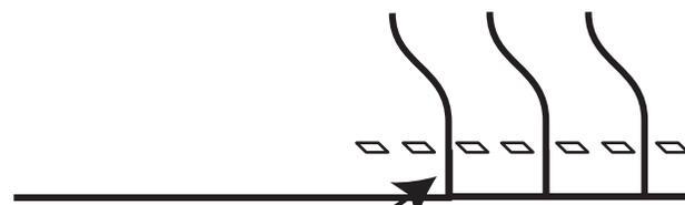
後で縫う際に、上図のように重なった革をまたげるように菱目打ちの際に幅を調整する
